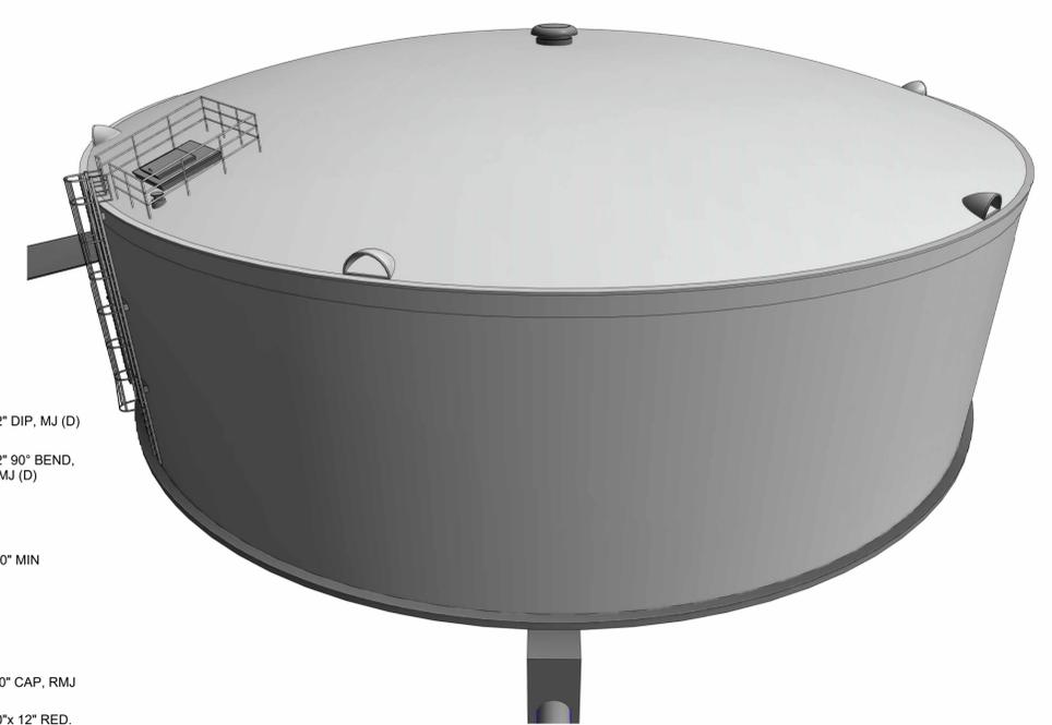
11.0A GROUND STORAGE TANK NO. 2 ISOMETRIC
